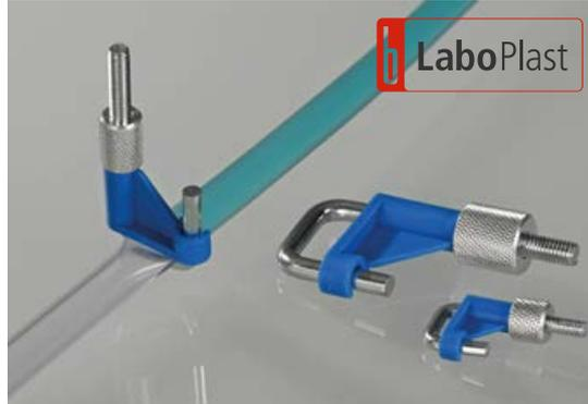
Easy-Click-Verschluss – stop-it kann in jeder Position geöffnet und geschlossen werden – ohne lästiges Auf- und Abschrauben. Hochwertiges Material – stop-it ist aus dem hoch hitze- und chemikalienbeständigen Kunststoff PVDF gefertigt. Der Bügel ist aus Stahl, verzinkt.
